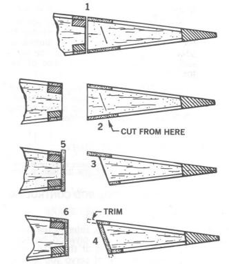
STEP 1 - SAW AILERON OFF AT BACK OF REAR SPAR.
